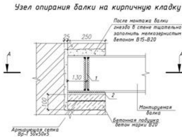
Рисунок 3 (а). Узел опирания балки на кирпичную кладку
