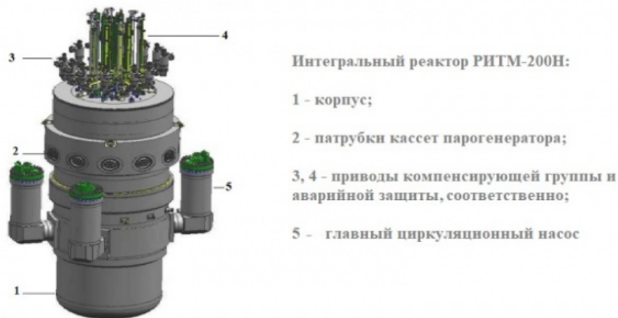
Рис. 1. Реакторная установка РИТМ-200Н [Петрунин: 4]
