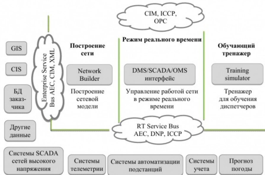
Рис. 3. Обобщённая схема архитектуры ИИСУ [Мозохин: 56]
