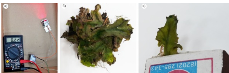
Рис. 2. Подготовка к испытаниям воздействия лазерного луча: а – ток потребления лазера; б – источник образца; в – фиксация образца. Фото автора
