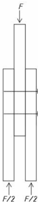
Рис. 7. Схема загрузки образца 8
