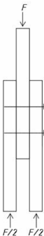
Рис. 3. Схема загрузки образца 1
