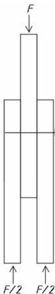
Рис. 15. Схема загрузки образца 7
