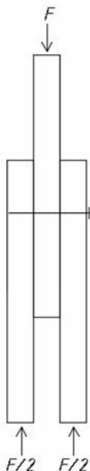
Рис. 12. Схема загрузки образца 2
