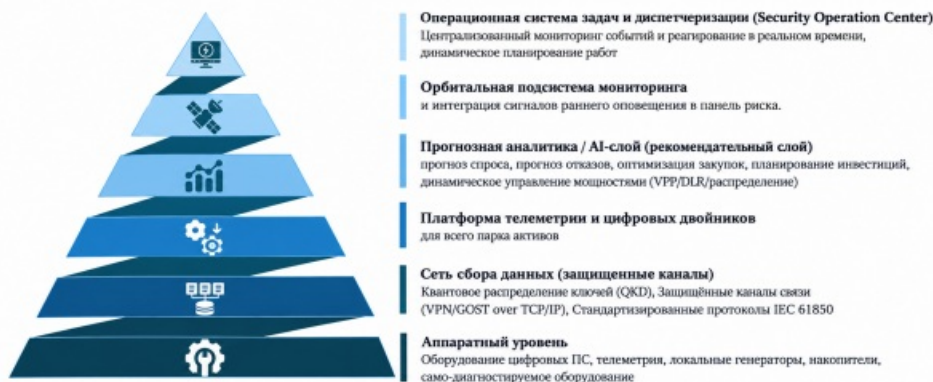
Рис. 2. Модель интеллектуальной интегрированной системы управления и мониторинга распределительными электрическими сетями. Составлена автором
