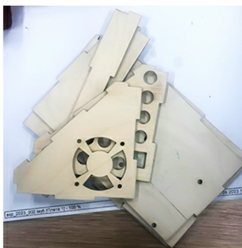
Рис. 5. Детали корпуса устройства (3 мм фанера)
