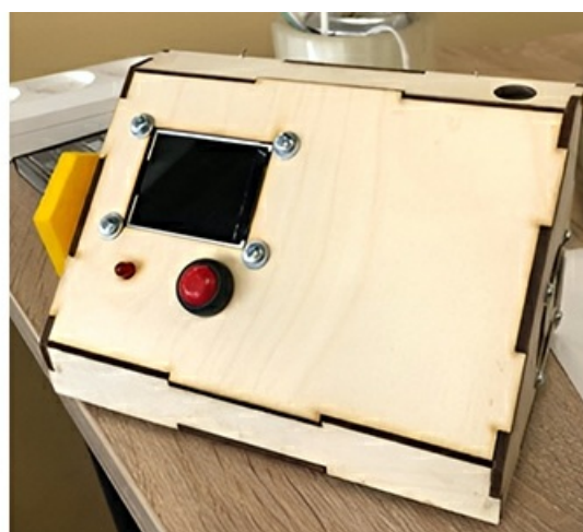
Рис. 6. Собранный корпус устройства (вид спереди)
