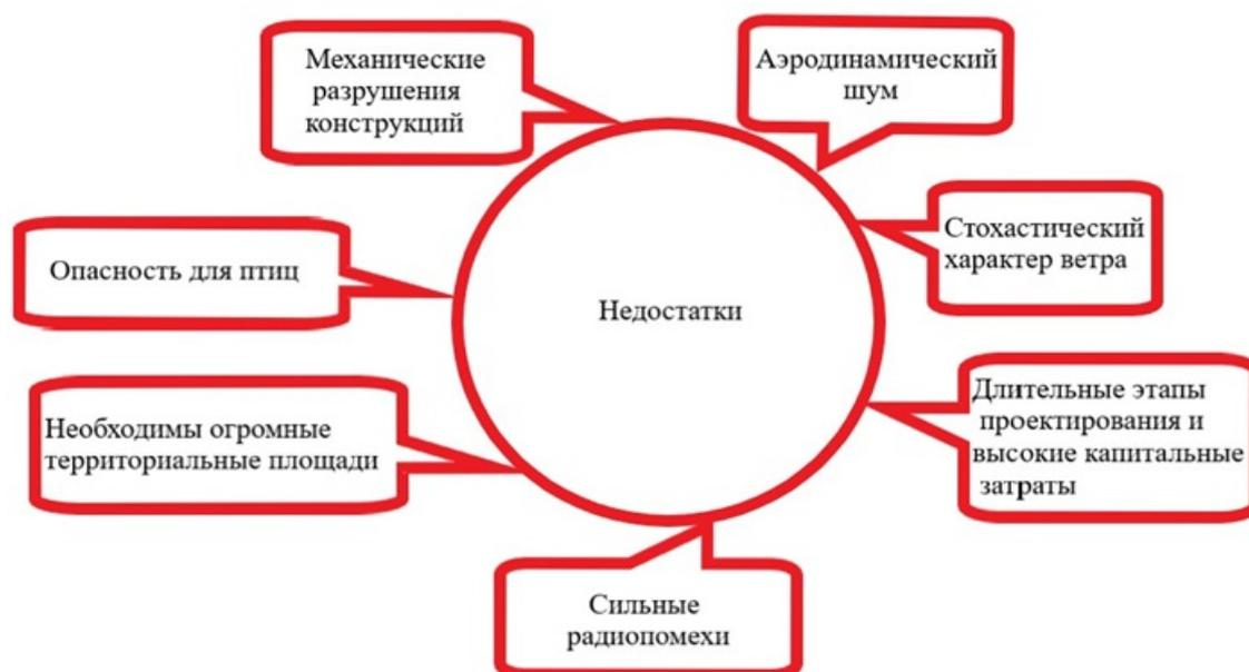
Рис. 1. Недостатки лопастных ветрогенераторов
