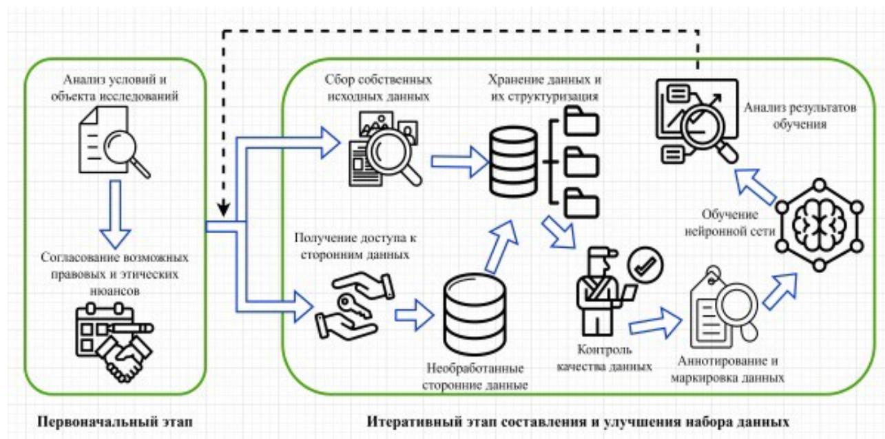
Рис. 1. Схема подготовки данных для видеоаналитики объекта и его ключевых точек
