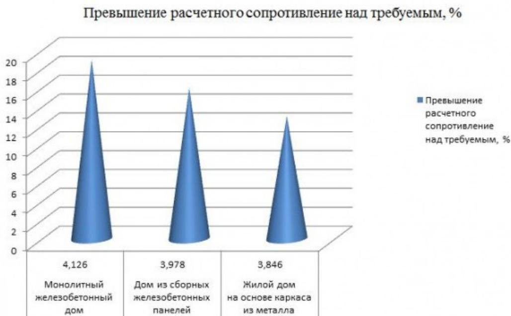
Рисунок 4 - Пре́вышение расчетного термического сопротивления над требуемым, %
