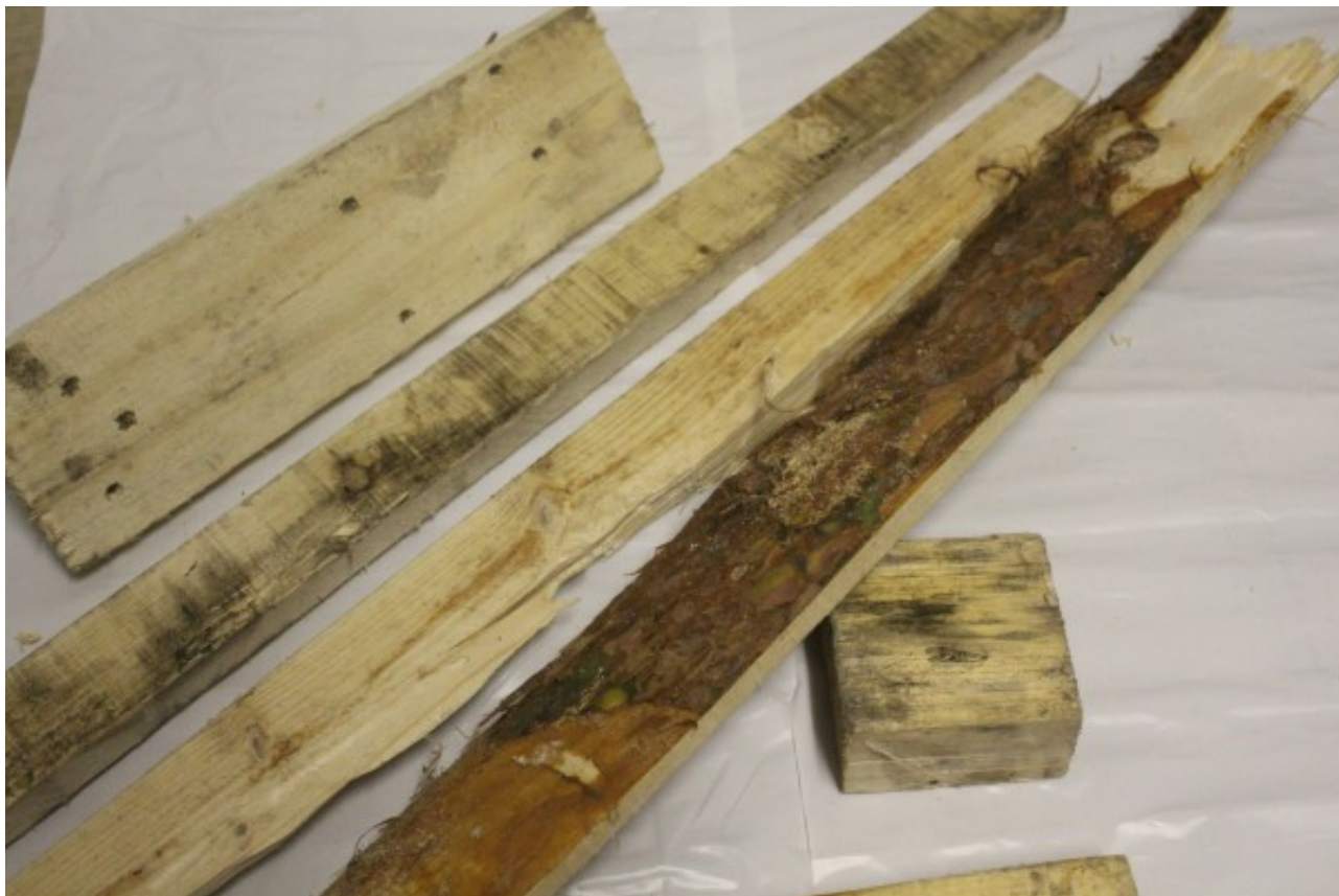
Рис. 2. Элементы древесных упаковочных материалов с признаками повреждений
