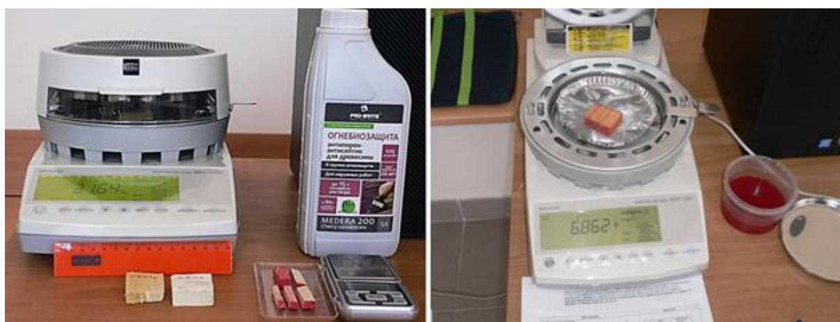
Рис. 1. Устройство для анализа влажности МОС-120Н и жидкость для пропитки
