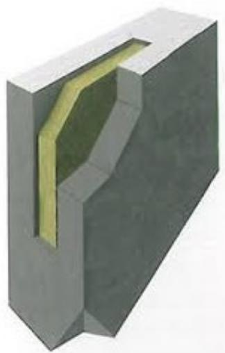
Рисунок 2 - Разрез стены дома из сборных железобетонных панелей
