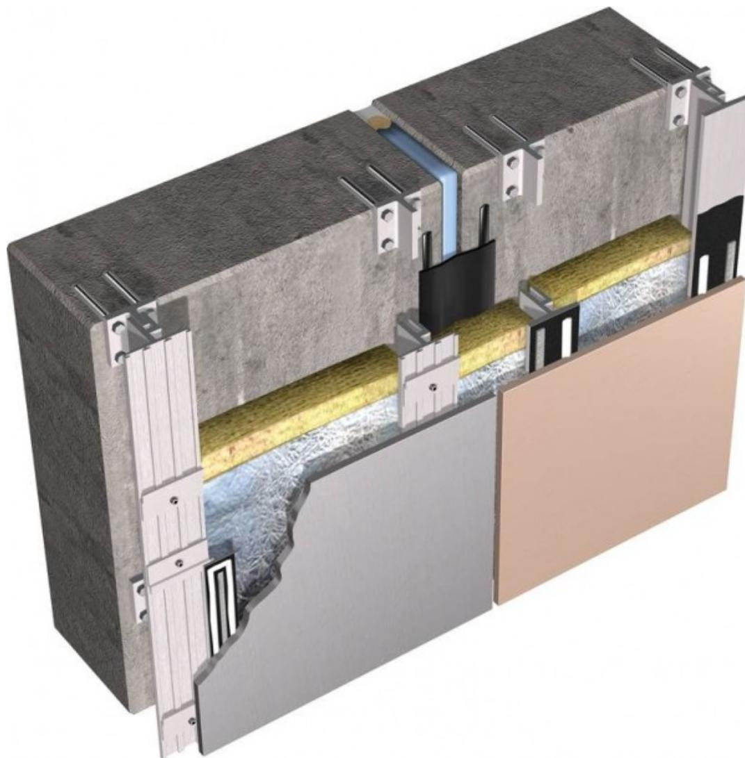
Рисунок 1 - Разрез стены монолитного железобетонного дома с вентилируемым фасадом
